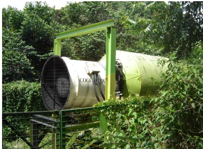
(iii) Fan di RC-12 (Utara) 132 kW; 200-2400 Pa; 28-56 m 3 /s
