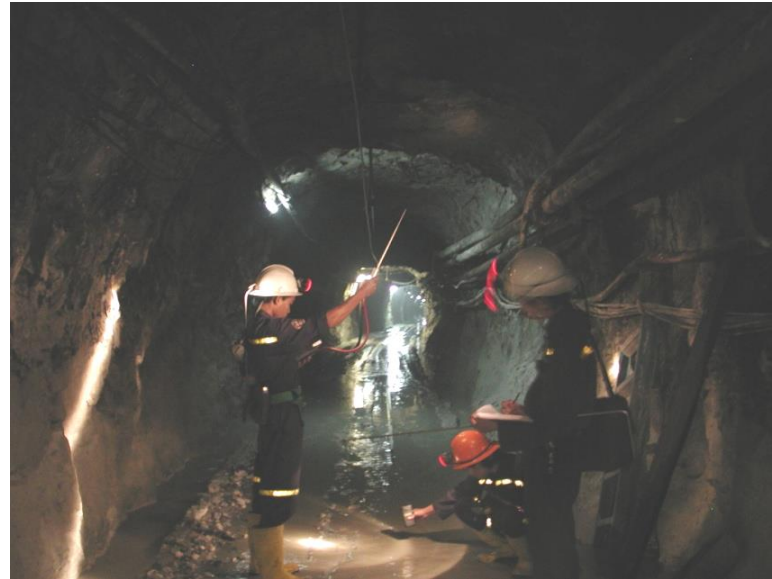
(ii) MHL 500 ( \pm 35 \text{ m}^3/\text{s} ) Dimensi jalur ini adalah 3,3 m x 4 m
