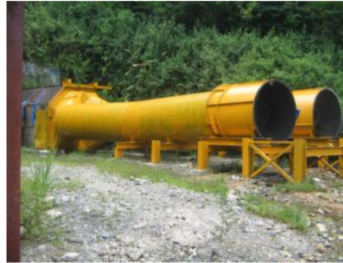
(ii) Dua buah fan dirangkaikan Paralel di L 700 (Selatan), masing-masing: 132 kW; 250- 2500 Pa; 28-55 m 3 /s
