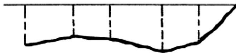
c. Penampang Tak Beraturan (Irregular Section) Timbunan Luas dihitung dengan Segitiga, Koordinat atau Planimeter
